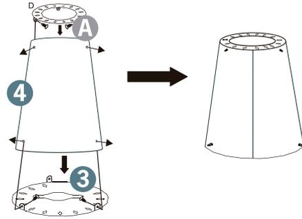
**Paso 3:** Estructura los pétalos **2** con la pieza **1**
