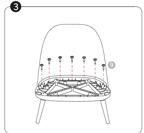
Fija el respaldo a la base de la silla, utilizando los tornillos **9**.
