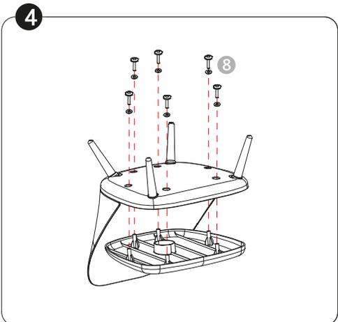
Dale la vuelta a la silla y ensambla la base **3** de la manera indicada. Utiliza tornillos **8**.
