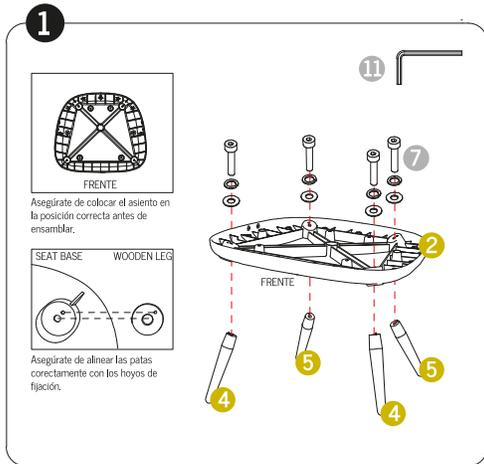
Posiciona el asiento **2** como indica la figura y ensambla las patas de la silla utilizando tornillos y golillas **7**.
