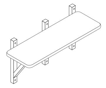
Paso 2: Usando los tarugos C y los tornillos B fije la estructura al muro uyudándote con un destornillador.
