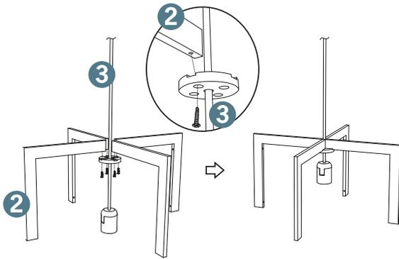
**Paso 2:** Una las cuatro partes de la pantalla uniéndolas a través de las pestañas.
