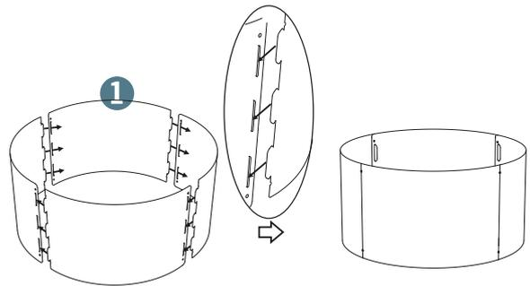
**Paso 3:** Utilice los tornillos para fijar la pantalla a la estructura previamente armada.
