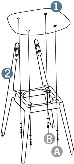
**Paso 2:** De la misma manera, fije el respaldo a la estructura de la silla.
