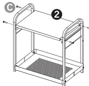
**Paso 2:** Agregue la bandeja superior **2** a la estructura armada. Para ello use 4 pernos **C**.
