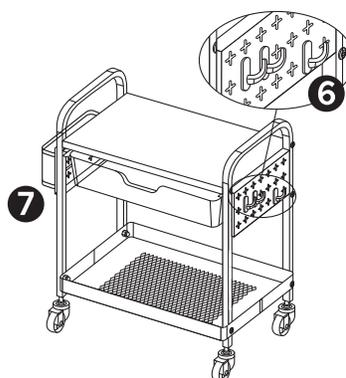
**Paso 8:** Agregue los accesorios en en la posición que le acomode del panel ranurado (ganchos **6** y canasto **7**).
