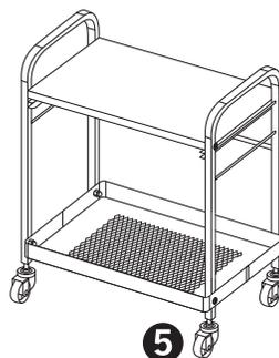
**Paso 4:** Encaje las 4 ruedas **5** a los extremos inferiores de los laterales.
