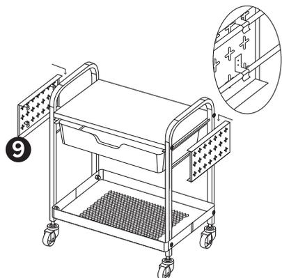
**Paso 7:** Encaje los paneles perforados **9** en los laterales del carro.
