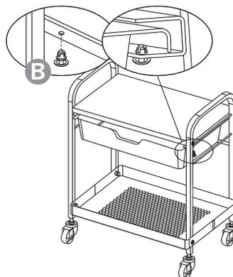
**Paso 6:** Inserte los dos topes **B** en los laterales del carro. Estos evitarán que se desprenda el cajón al abrirlo.
