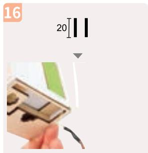
Cortar dos tubos termorretráctiles negros de 20 mm y colocarlos en los cables como se indica. Calentar los tubos para que se retraigan.
