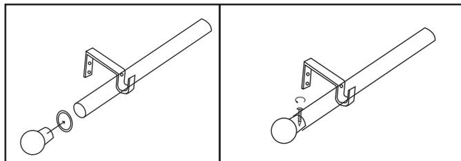
4 Recuerde poner una argolla o presilla entre los brackets y los terminales de la barra para fijarla.
