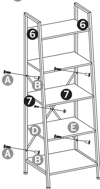
**Paso 3:** Una las curucetas **7** a los laterales **6**. Para esto utilice 4 pernos **A** y 4 tuercas **B**. Fije los travesaños en el centro usando 1 perno **D** y 1 tuerca **E**.
