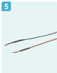
Cortar los tubos termorretráctiles de 20mm y colocarlos en los cables como se indica.
