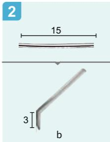
2 Doblar el alambre metálico de L15mm como se muestra. A continuación, aplanar el lado corto.
