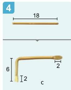
Cortar un alambre metálico de L18mm. Doblar como se muestra y aplanar ambos extremos.
