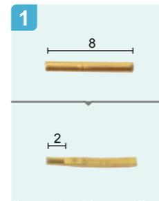
Corta el cable metálico. A continuación, aplana como se muestra con unos alicates de punta.
