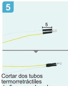
5 Cortar dos tubos termorretractiles de 5 mm y colocarlos en los cables como se indica. Calentar los tubos para que se encojan. (Evitar que los cables se quemen).
