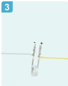
3 Enrollar los cables por separado de la luz. (Observa el ánodo y el cátodo).
