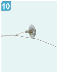
10 Coloca el tubo termorretractil en los cables e introduce el tallo en el tubo.
