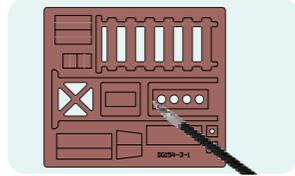
Retirar la parte de madera con el cuchillo de precisión. -Pulir con papel de lija para la preparación. (Es más fácil quitar las piezas cortando el borde por delante y por detrás).
