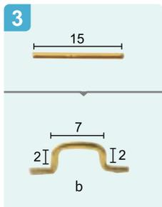
Cortar un alambre metálico de L15mm. Doblar como se muestra y aplanar ambos extremos.
