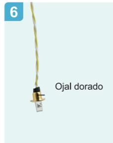
6 Enrosacar ambos cables en una sola hebra. A continuación, colocar el ojal en ellos.
