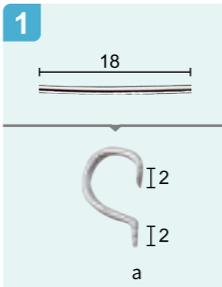
1 Cortar el alambre metálico y doblarlo como se indica. A continuación, aplanar L2mm en ambos extremos.
