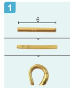
Cortar un alambre metálico de L6mm. Aplanarlo y doblar como se muestra.
