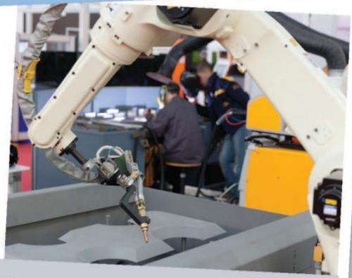
Cada articulación de un brazo robótico tiene un número determinado de grados de libertad, que puede ser inferior al número máximo de seis. Por ejemplo, no todas las articulaciones del brazo robótico pivotante pueden girar 360 grados.
