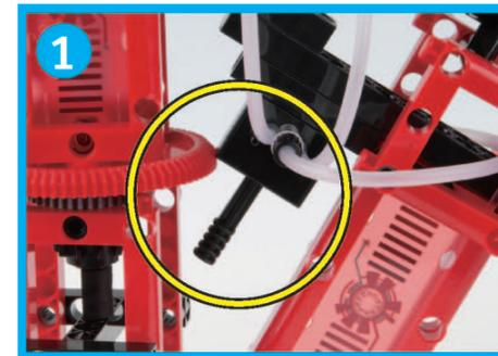
Pon la palanca del interruptor en la posición central.
