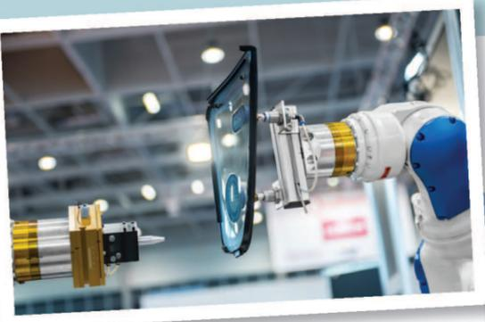
A menudo, el extremo del brazo robótico, llamado efector final, se diseña por separado del resto del brazo. Está diseñado para interactuar con los objetos de su entorno, como una mano humana, pero para tareas especializadas como soldar, agarrar, girar, aplicar materiales, etc.
